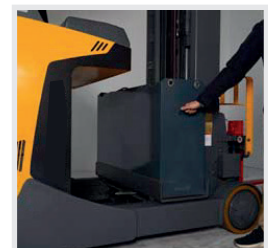
PARA FACILITAR EL MANTENIMIENTO O LA SUSTITUCIÓN DE LA BATERÍA SE DESPLAZA EL MÁSTIL Y SE EXTRAE LA BATERÍA POR EL LATERAL.
