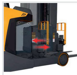
PARA FACILITAR EL MANTENIMIENTO O LA SUSTITUCIÓN DE LA BATERÍA SE DESPLAZA EL MÁSTIL Y SE EXTRAE LA BATERÍA POR EL LATERAL.
